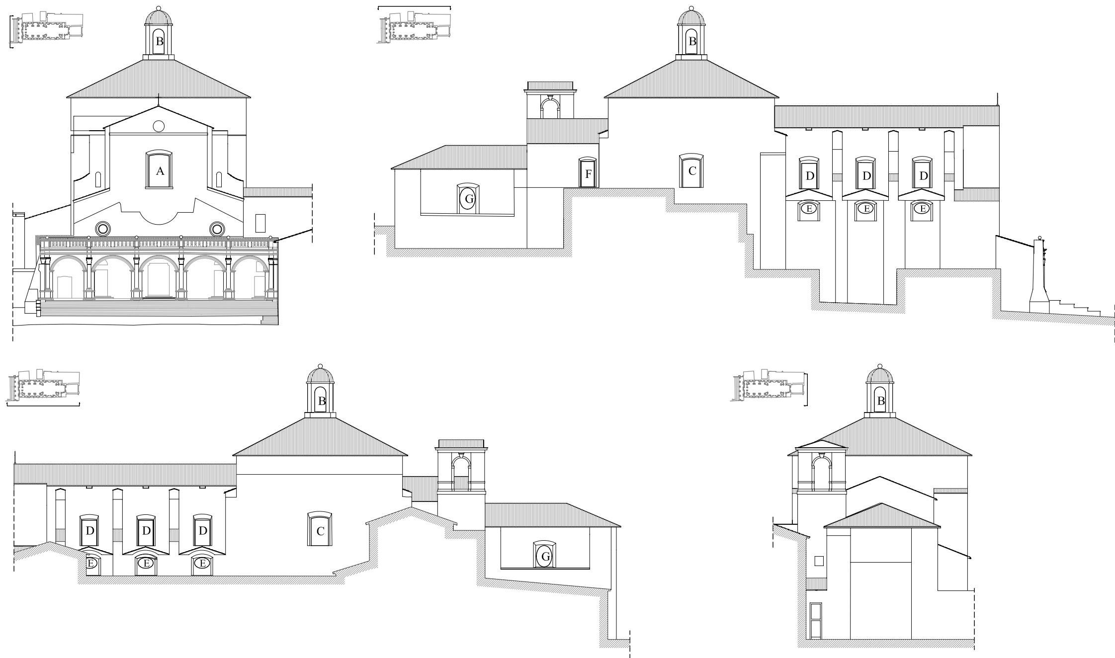
PROSPETTI CON L'INDIVIDUAZIONE DEGLI INFISSI DELLE FINESTRE - STATO POST OPERAM nel rapporto di scala 1:200
